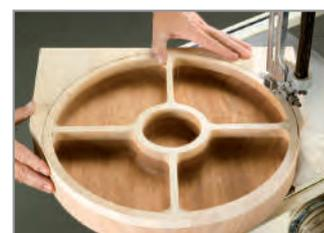
Rifinite la parte esterna del vassoio utilizzando una sega a nastro.
