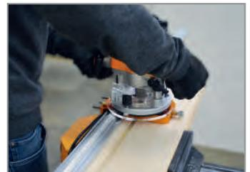
Iniziate la lavorazione spostandovi sulla morsa, tramite l'ausilio del vostro PGD-1. Otterrete un canale perfettamente lineare su tutta la lunghezza lavorata.
