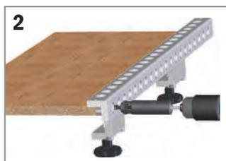
2 Fissare il sistema sull'altro pannello, settare i perni di arresto e posizionare la profondità di foratura. Eseguire le forature orizzontali.
