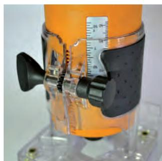
Regolazione micrometrica della profondità di fresatura.
