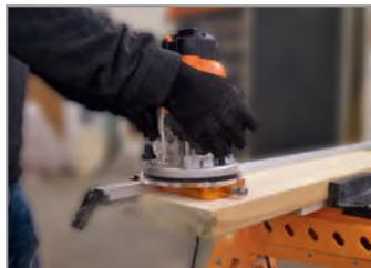
Posizionate la fresatrice (completa di base) sul PGD-1 tramite il foro di inserimento.
