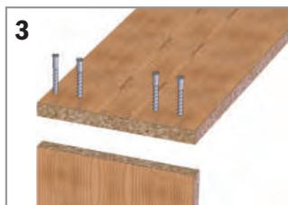
3 Oppure usate punte per fori passanti per giunzioni a mezzo di viti autofilettanti.
