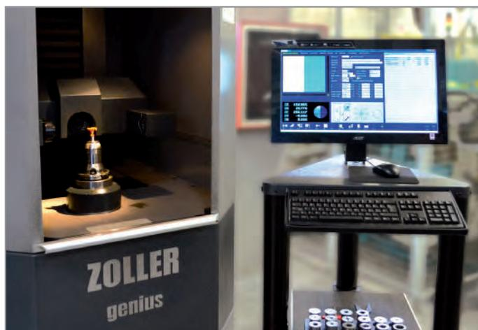
Il sistema di controllo CMT completamente automatizzato.
