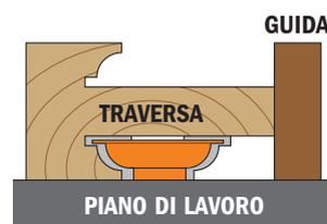
3. Fresate nella parte inferiore del tenone per realizzare la fine della traversa.
