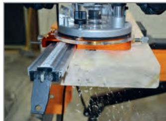
Verificate la profondità di taglio e il punto di inizio della fresatura con l'aiuto delle tre linee guida, che identificano il punto di inizio del canale, per i diametri delle frese più comuni (12-10-8mm sul fronte, 1/2"-3/8"-1/4" sul retro).
