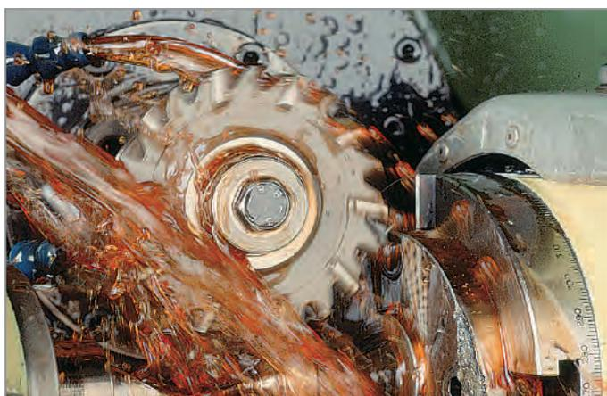
**Corpi in acciaio forgiati a caldo per frese di grande diametro.** Non tutte le frese sono uguali, spesso anche differiscono anche nel modo in cui vengono prodotte. Alcune di queste necessitano di lavorazioni ulteriori rispetto alle altre, come la forgiatura a caldo di corpi fresa di diametro maggiore prima di esse portate a misura.
