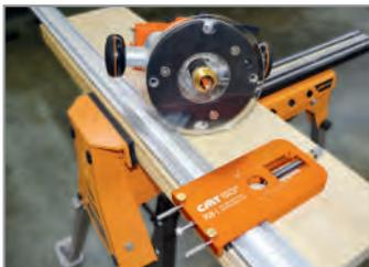
Montate sulla base in plastica la boccola di guida (grazie al relativo anello), quindi assemblate la base alla vostra fresatrice. Posizionate la morsa sul pezzo da lavorare e il vostro PGD-1, tramite le viti per la regolazione della battuta lo vincolerete alla morsa.
