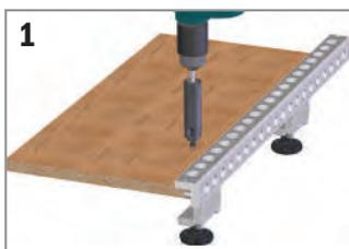
1 Posizionare il sistema di foratura sul pannello, settare i finecorsa e serrare il pezzo. Posizionare la profondità di foratura e serrare la punta all'adattatore che va montato sul trapano. Eseguire le forature verticali.
